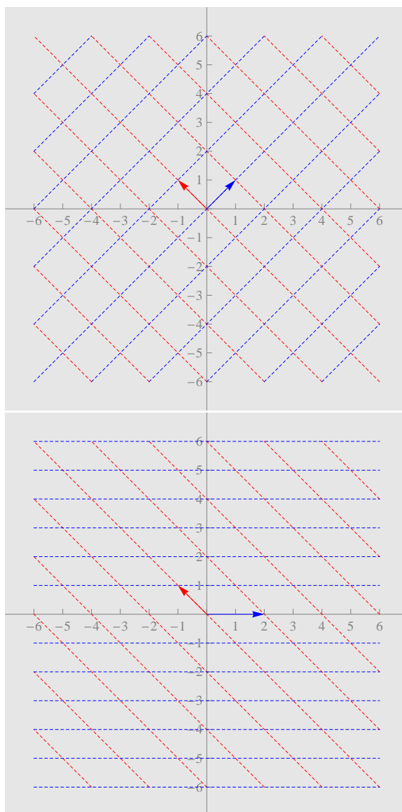
Figura 1.7: Arriba: Espacio vectorial generado por (1, 1) y (-1, 1) Abajo: el EV generado por (2, 0) y (-1, 1)
